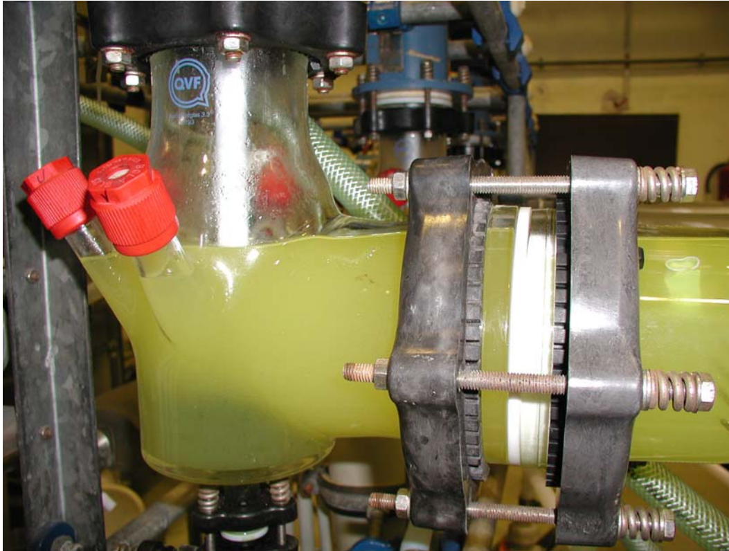
Abb. 5: Durchmischung der organischen und der wässrigen Phase im Mixer
