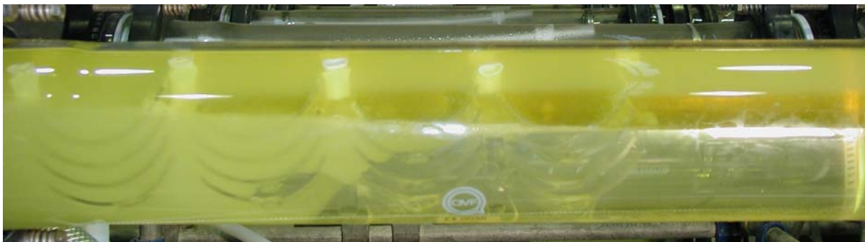
Abb. 6: Phasentrennung der wässrigen und der organischen Phase im Abscheider mit Einbauten
