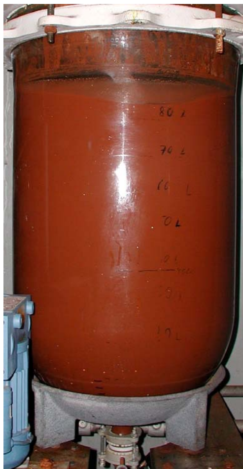
Abb. 2: Laugung der Klärschlammmasche
